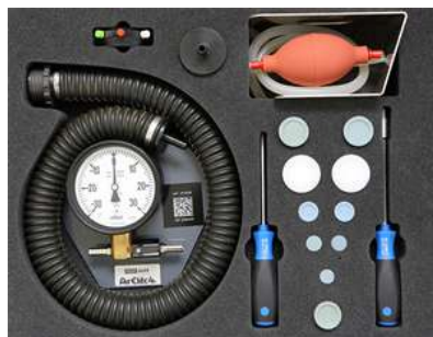
Figura 4 Prueba de las válvulas de control
