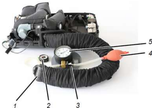
Figura 11 Prueba de estanqueidad
